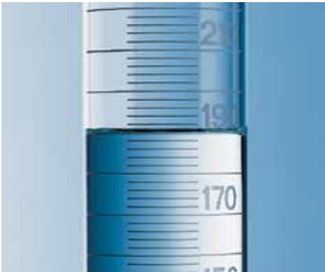
SILBERBRAND. Divisiones cortas. Lectura a la altura del punto más bajo del menisco.
