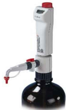
3. Retirar el botón giratorio rojo y ajustar el valor real determinado (aquí 9,90 ml).
